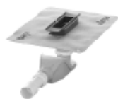
Model: 4981.80 štandardné odtokové teleso konštrukčná výška: 95–155 mm výška uzatváracej vody: 50 mm výkon odtoku: 0,5–0,75 l/s*
