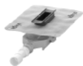
Model: 4981.81 odtokové teleso pre sanácie konštrukčná výška: od 70 mm výška uzatváracej vody: 25 mm výkon odtoku: 0,4–0,7 l/s*
