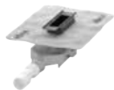
Model: 4981.81 odtokové teleso pre sanácie konštrukčná výška: od 70 mm hĺbka vodného uzáveru: 25 mm výkon odtoku: 0,4–0,7 l/s*
