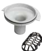
kolmý model bez: zápachový uzáver sietková vložka výkon odtoku pre výšku hladiny 10 mm 1,2 l/s výkon odtoku pre výšku hladiny 20 mm 1,2 l/s model 4982.83
