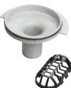
kolmý model bez: zápachový uzáver sitková vložka výkon odtoku pre výšku hladiny 10 mm 1,2 l/s výkon odtoku pre výšku hladiny 20 mm 1,2 l/s model 4982.83
