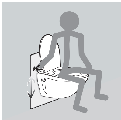
Obr. 2 – 67 WC sedátko – výškové nastavení dolů
