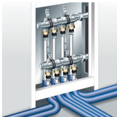
Obr. 1 – 39 Samostatné připojovací vedení
