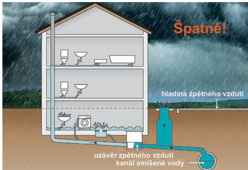
Obr. 3 – 150 Uzávěr zpětného vzduť – nesprávné uspořádání!
