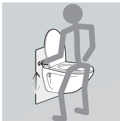
Obr. 2 – 68 WC sedátko – výškové nastavení nahoru
