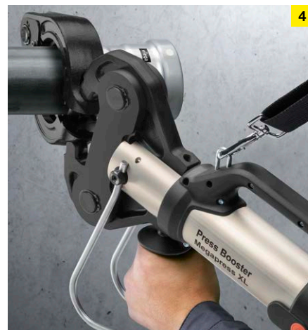
Spojky Megapress XL sa zlisávajú lisovacím nástrojom a nadstavcom Press Booster jednoducho, rýchlo a bezpečne.
